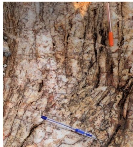
FIG 48: HIGHLY JOINTED QUARTZ
